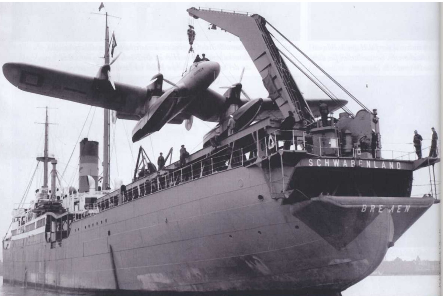
Die Flugzeugstützpunktschiffe der DLH gewährleisteten in den 1930er Jahren einen reibungslosen transatlantischen Postverkehr. Oben links: Dornier-Wal-Flugboot „Taifun“ auf der Schleuderanlage der „Friesenland“; Oben rechts: Bedienanlage für die Katapultanlage der „Westfalen“. Unten: Das Seeflugzeug Blohm & Voß Ha 139 „Nordmeer“ am Kran der „Schwabenland“
