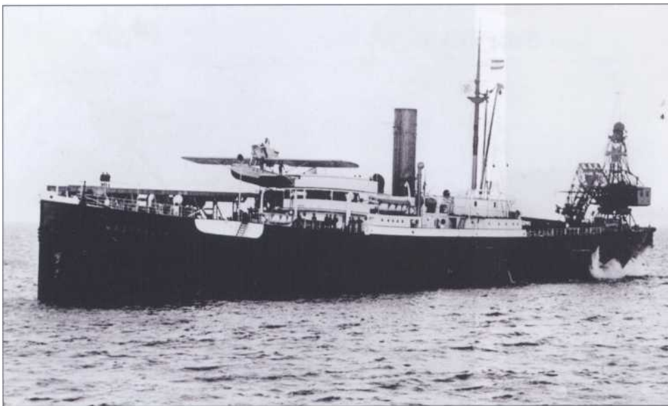
1934 setzte die DLH für den Luftpostdienst nach Südamerika ihren ersten schwimmenden Flugzeugstützpunkt ein — den Dampfer „Westfalen“. Hier wurden die Flugboote nach vorne geschleudert.
