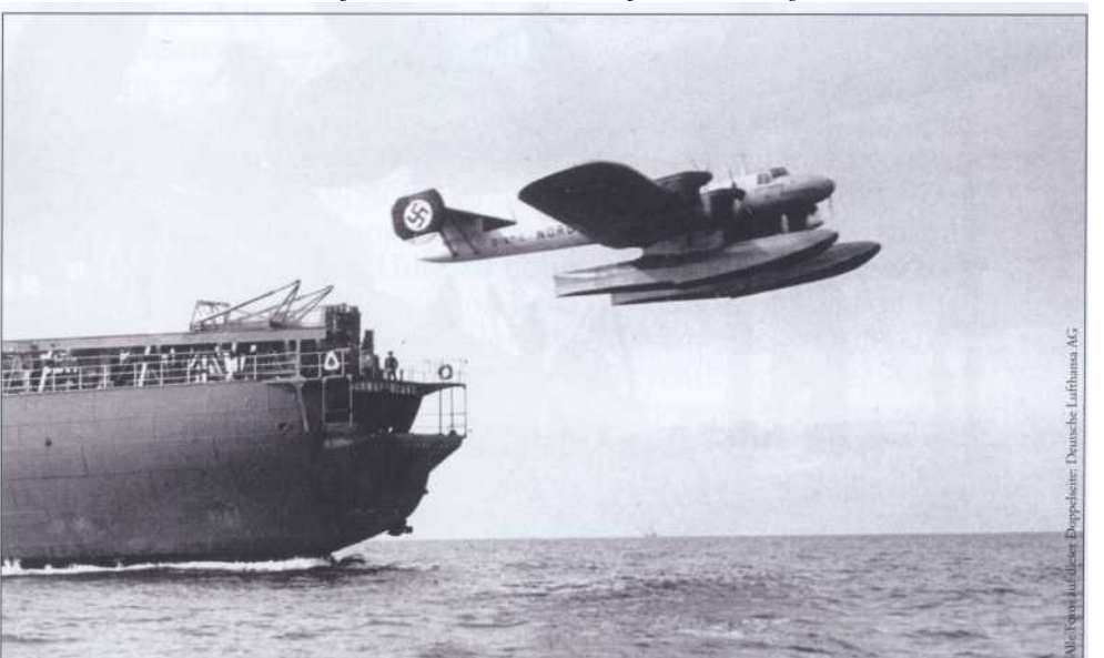
Deutlich zu erkennen ist, daß die Flugboote nach hinten katapultiert wurden, was den umklappbaren Kran notwendig machte.
