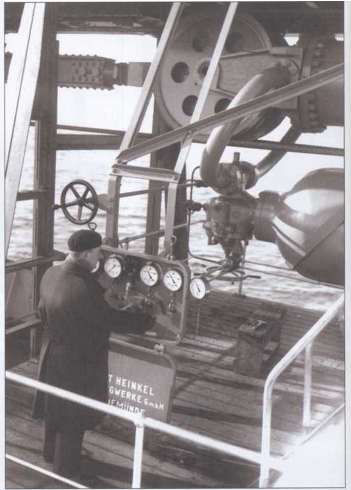
Die Flugzeugstützpunktschiffe der DLH gewährleisteten in den 1930er Jahren einen reibungslosen transatlantischen Postverkehr. Oben links: Dornier-Wal-Flugboot „Taifun“ auf der Schleuderanlage der „Friesenland“; Oben rechts: Bedienanlage für die Katapultanlage der „Westfalen“. Unten: Das Seeflugzeug Blohm & Voß Ha 139 „Nordmeer“ am Kran der „Schwabenland“
