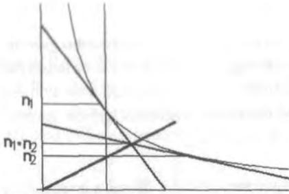
Um zwei Zahlen zu multiplizieren, muß man deren Tangenten schneiden. Dort, wo der »mittlere Leitstrahl«, der den Ursprung mit diesem Schnittpunkt verbindet, die y-Parallele (mit Abstand eins) schneidet, kann das Produkt  $n_1 \cdot n_2$  abgelesen werden. (auf dem Schnittpunkt der x-Parallelen kann das Produkt der Kehrwerte abgelesen werden.)
