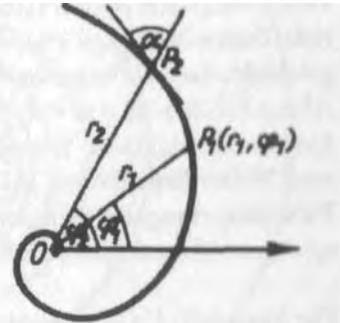
Der Pol ist ein asymptotischer Punkt. Die Konstante  $a$  ändert nur die Wahl des Maßstabes und ist für das Erscheinungsbild nicht relevant.  $k = \cotan\alpha$ , wobei  $\alpha$  der Schnittwinkel der Kurventangente mit dem vom Ursprung ausgehenden Strahl ist. Für eine unterschiedliche Wahl von  $\alpha$ , bekommt man unterschiedliche Spiralen:
