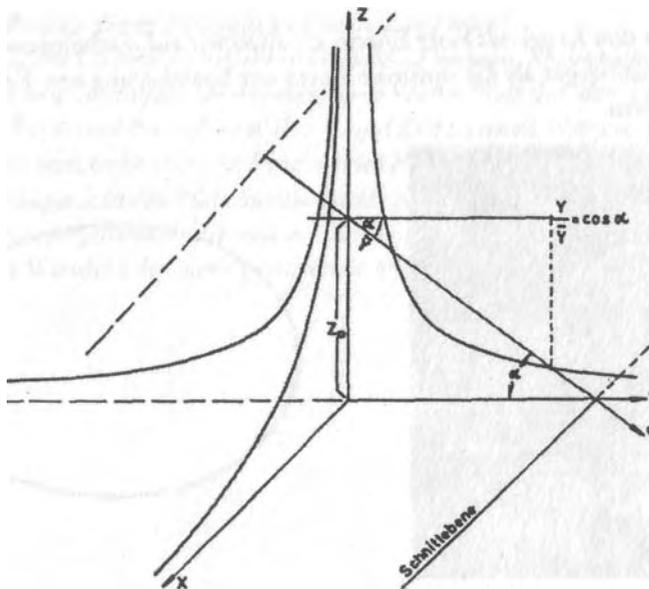
Daraufhin schneiden wir den Kegel mit dieser neuen Basisebene (also  $z = 0$ ) und erhalten die folgende explizite Gleichung für die Eikurve:<sup>27</sup>
