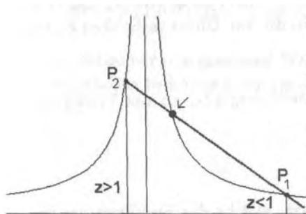
Wir gehen wieder von den Punkten  $P_1(1/z_1, z_1)$  und  $P_2(1/z_2, z_2)$  aus, wobei beachtet werden muß, daß zwischen diesen beiden Punkten nicht noch ein weiterer Schnittpunkt existiert, da sonst nicht die Werte der eigentlichen Achse berechnet werden. (Dieses Problem tritt auf, wenn ein  $z > 1$  und das andere  $z < 1$  ist.)
