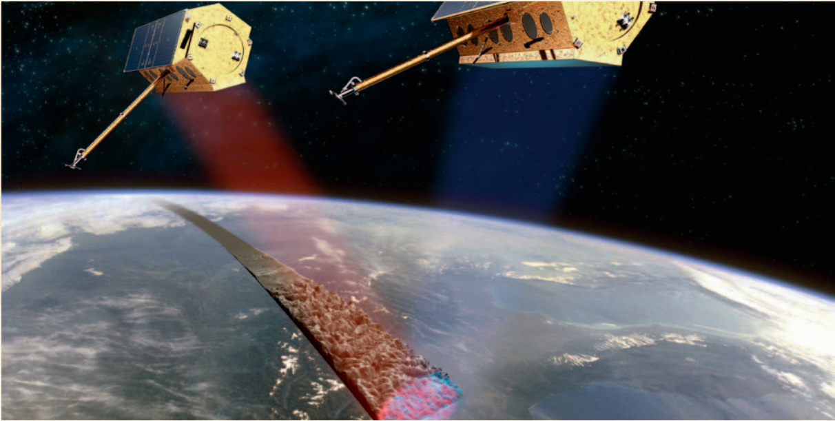
Die deutschen Erdbeobachtungssatelliten TerraSAR-X und TanDEM-X liefern Daten zur Erstellung eines dreidimensionalen Höhenmodells in einzigartiger Qualität. Diese Daten werden auch für kommerzielle Zwecke genutzt.
